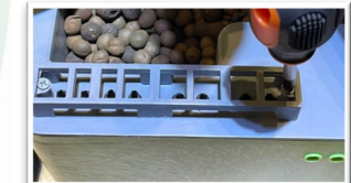
B4: Dùng tước nơ vít lắp lại khung bảo vệ đầu phát ion
