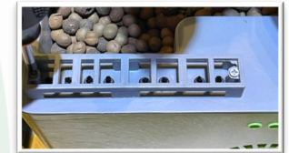
B2: Dùng tước nơ vít tháo 2 ốc ở khung bảo vệ đầu phát ion
