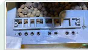
B3: Dùng khăn sạch lau trên đầu phát ion và phần vỏ máy xung quanh
